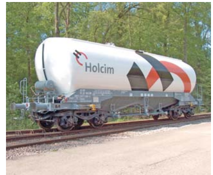
69 Tonnen Zement fasst der neue Bahnwagen.
