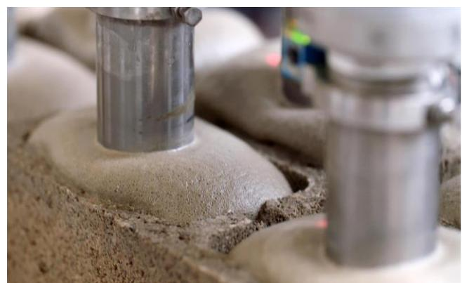
Airium™ kann vielseitig zur Dämmung eingesetzt werden. Vorläufig wird es in Frankreich und Österreich zur Verfüllung der Kammern in Mauersteinen sowie in Marokko bei der Isolation von Dachterrassen verwendet. Der Einsatz von Mauersteinen mit Airium™ erlaubt es, das Gebäude zeitgleich zu bauen und zu dämmen. Dies bringt hohe Zeitersparnisse mit sich. Des Weiteren sorgt der Dämmstoff dafür, dass die Wände nicht zusätzlich isoliert werden müssen und kann dadurch die bewohnbare Fläche vergrössern.
