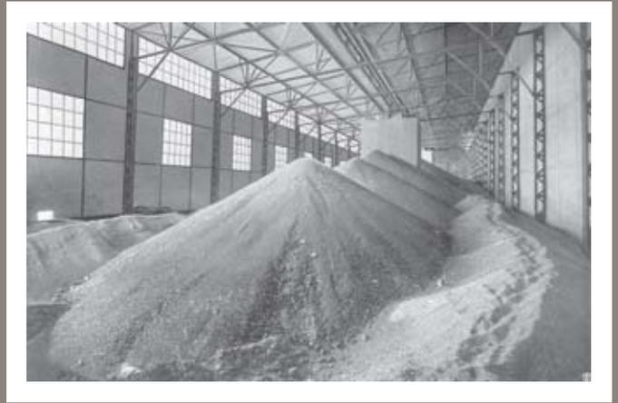
Klinkerhalle zur Lagerung des Zwischenproduktes.
